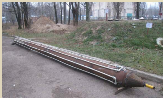
Вилучення відновлюваної теплоти ґрунту за допомогою бетонної палі із теплообмінниками
